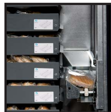
Bandejas de carga horizontal y ascensor de entrega de producto Horizontal loading trays and product delivery by elevator
